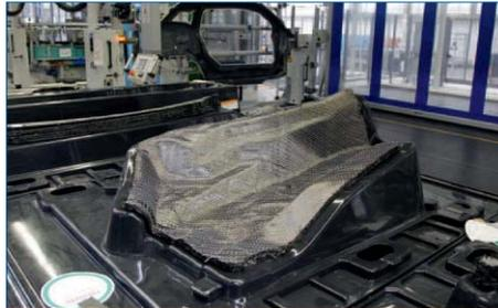
CFK-Teilefertigung für den elektrischen i3 von BMW. Es ist das erste in Großserie gebaute Auto mit einer Carbon-Fahrgastzelle.
