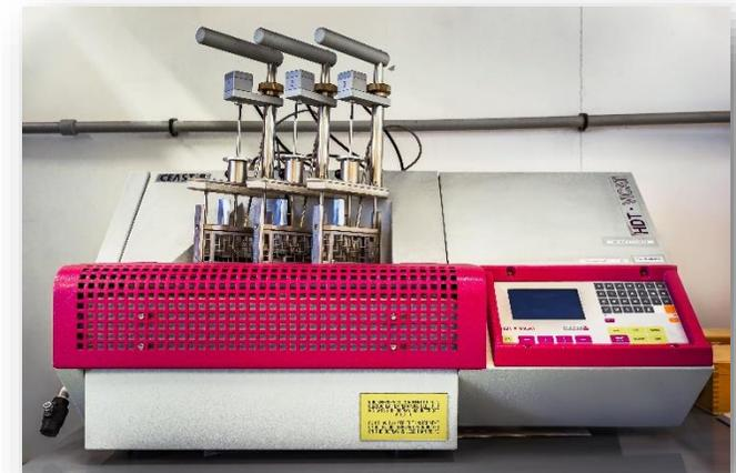
Система для термомеханических испытаний пластмассовых изделий
