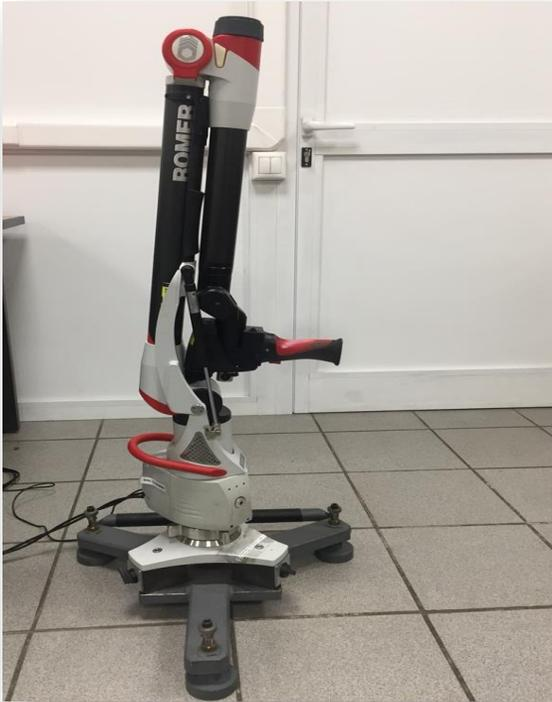
Мобильный измерительный комплекс оснащённый сканирующей головкой обеспечивает сенсорное измерение крупных деталей до **2 м** с точностью до **3 мкм**
