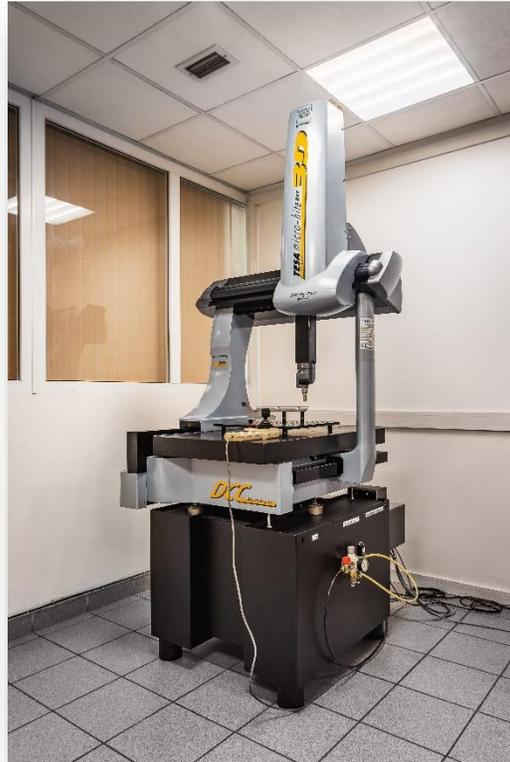
Измерительный 3-D комплекс обеспечивает высокоточное измерение деталей параметров **750x450x400мм**
