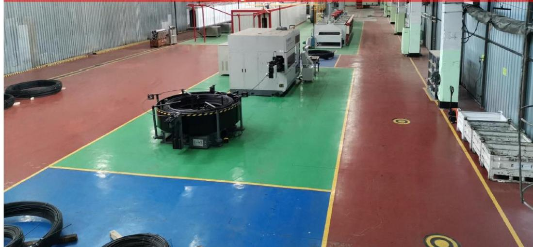
Автоматическая линия изготовления пружин холодной навивки с новой разметкой
