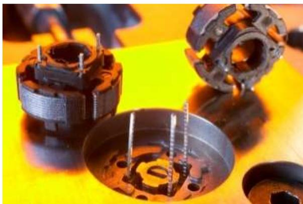
Mini - Stator mit integrierter Drahtzuführung
