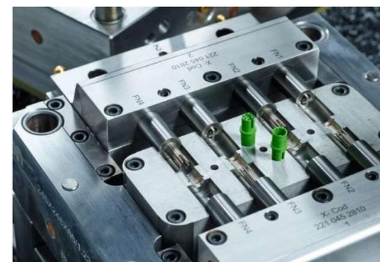
Form mit Wechselbacken für div. Rundsteckverbinder
