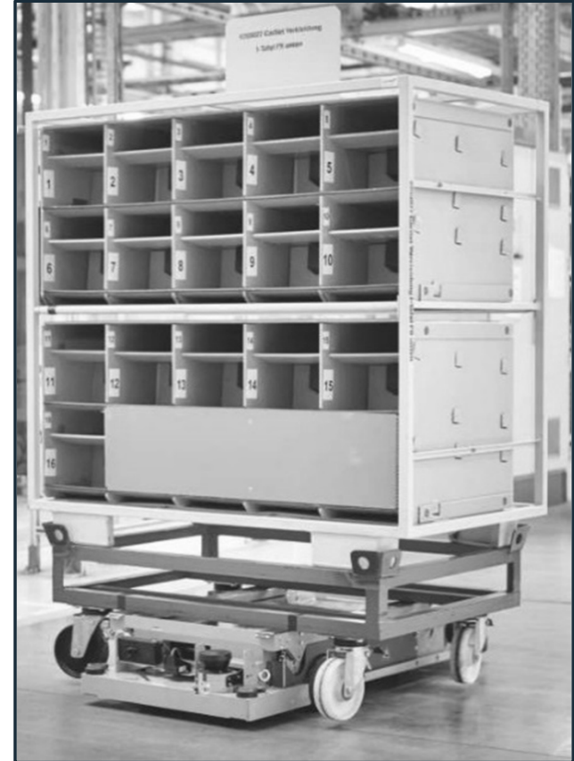
Beispiel: Fahrerloses Transportfahrzeug (FTF) inkl. Ladungsträger und Transportgut
