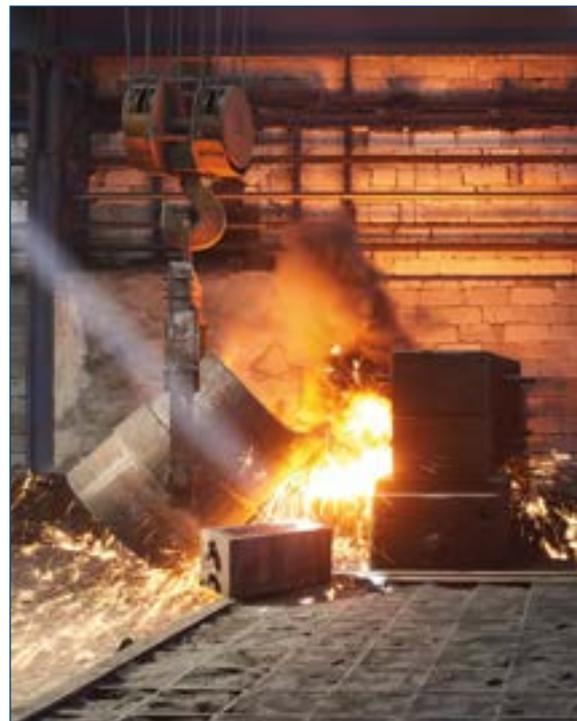
Mit dem Gießen von Presswerkzeug-Formen fängt die Produktion von Fahrzeugkarosserien an. Auch die Fertigung des modernsten, mit allen Software-Raffinessen ausgestatteten Elektroautos beginnt mit dieser körperlich harten sowie energieintensiven Arbeit. Die GL Gießerei Löbnitz ist eine von nur noch sehr wenigen in Deutschland, die diese Prozesse beherrschen.
