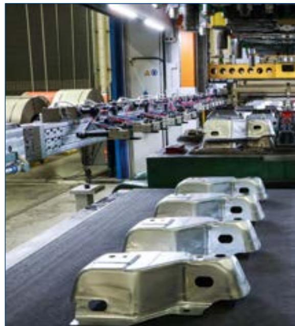
Produktion von Pressteilen auf moderner Stanz- und Umformtechnik. Fotos: Vollmann Group
