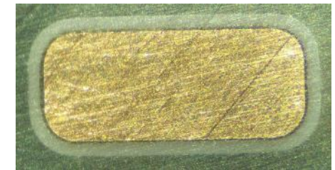
PEEK-PAI isolierter Flachdraht
